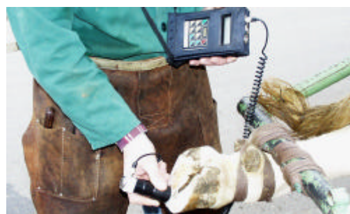
Abb. 8: Ermittlung der Hornhärte mit einem Härtemessgerät nach ShoreD.
