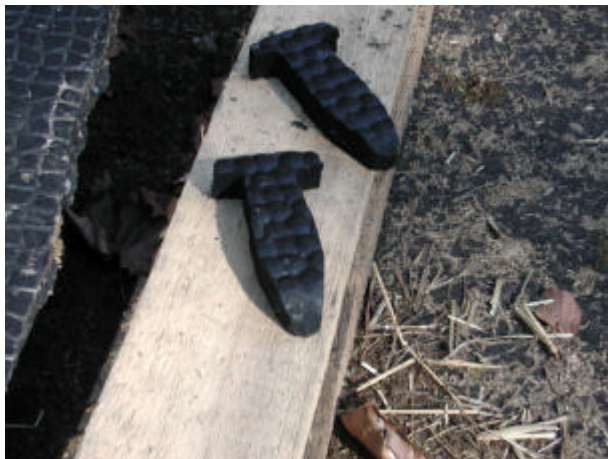
Abb. 4: Befestigungskeile für Gummiauflagen.
