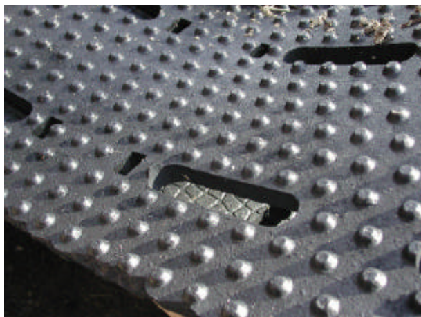
Abb. 1: Unterseite der Gummiauflage mit Noppenprofil (24 mm, V 1 )
