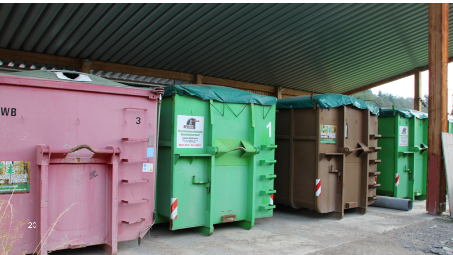
Abbildung 12: Die Trocknungscontainer in denen u.a. Brennholz und Körnermais getrocknet werden
